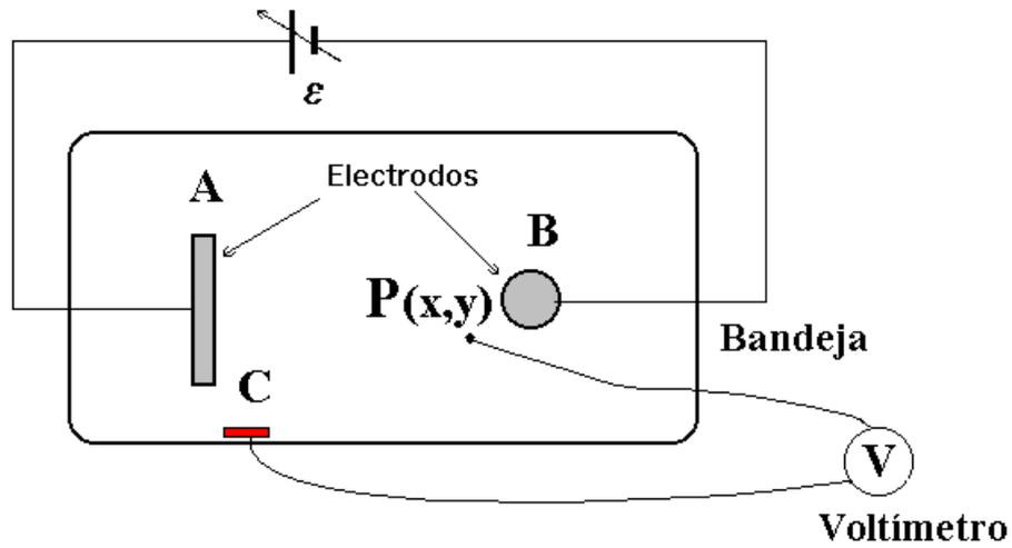
**Figura 2.** La bandeja contiene el agua, A es el electrodo positivo, B el negativo, C es un punto de referencia (fijo) a partir del cual se miden los potenciales, el cual puede coincidir o no con A o B. El punto P de coordenadas  $(x,y)$  donde se mide el potencial  $V(x,y)$ . **Nota:** Antes de conectar la fuente, pida que un docente revise su circuito y lo autorice a conectar la misma.
