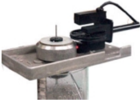
Figura 6: Dispositivo para medir la viscosidad del agua sin y con burbujas
