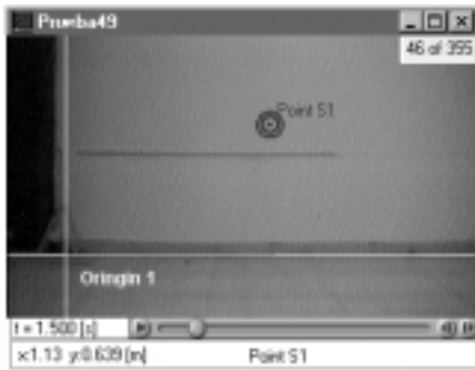
Figura 6: En esta imagen se muestra el punto asignado a la posición del proyectil, en el cuadro 195 de un total de 204, y el tiempo establecido para este cuadro es t = 5.233 seg. Esta información es utilizada, por ejemplo para el cálculo de velocidad instantánea.
