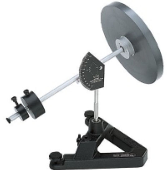
Figura 1 – Giróscopo utilizado en el experimento. Es el modelo Pasco ME-8960.
