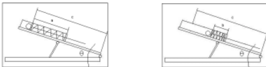
Figura 1a y 1b: Diagramas esquemáticos del aparato disparador de pelotitas de ping-pong. Sistema con resorte en reposo (1a). Sistema con resorte comprimido (1b).
