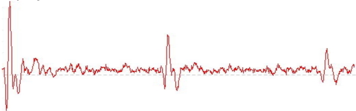
Figura 3. Comportamiento de una onda en un tubo con ambos extremos abiertos, con el parlante y el micrófono en el mismo extremo.
