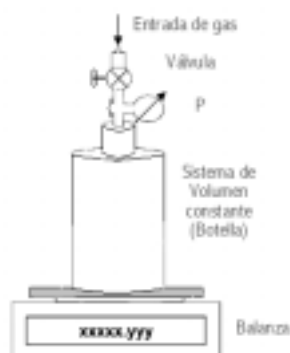
Fig.1: Dispositivo experimental usado, consistente en una botella con aire que tiene un manómetro para medir la presión y una válvula para presurizarla. La balanza registra la masa del sistema.
