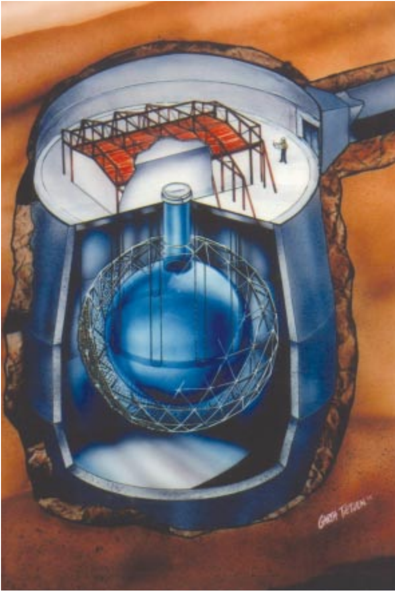
Figura 1. Diagrama esquemático del detector del observatorio de neutrinos de Sudbury ( Sudbury Neutrino Observatory, SNO ). El balón central contiene el agua pesada. La estructura geodésica que lo rodea, soporta los tubos fotomultiplicadores para detectar la luz Cerenkov. El tanque de cemento que contiene al detector está lleno de agua común ultrapura. Todo el detector se encuentra alojado dentro de una mina a unos 2000 m de profundidad. (Foto cortesía de SNO).
