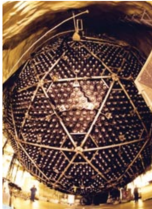
Figura 2. Esfera geodésica que soporta los tubos fotomultiplicadores del detector SNO. (Foto cortesía de SNO).
