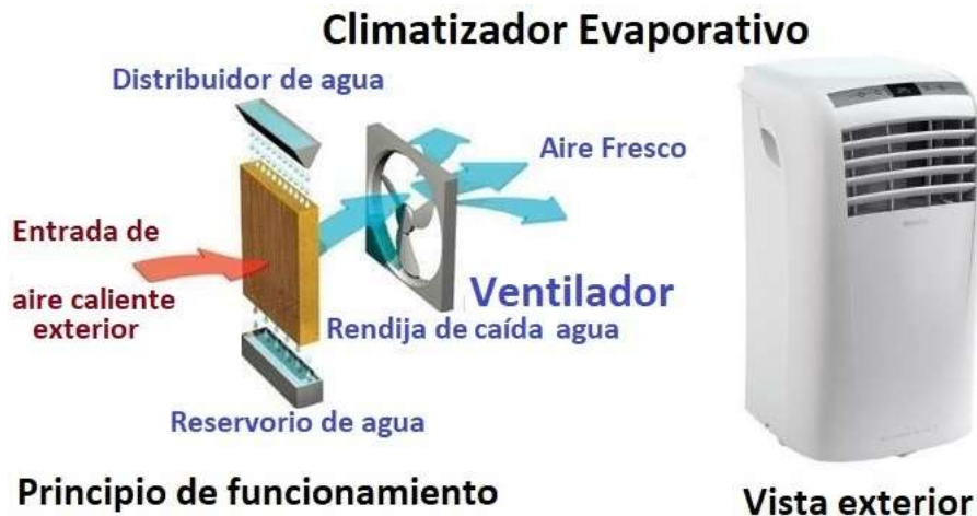
Figura 17. Climatizador evaporativo para refrigeración. A la izquierda se ilustra su funcionamiento, por una rejilla húmeda, se fuerza con el ventilador una corriente de aire caliente de medio. El agua de la rejilla se evapora absorbiendo calor, por lo que el aire se enfría y es impulsado al exterior. Así se genera un flujo de aire algunos grados más fríos que el entrante. Muy adecuado para climas de humedad relativa baja (secos).
