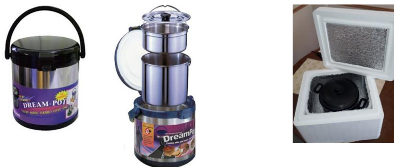
Figura 1. Izquierda: Olla Dream Pot, diseño Australiano Aislante: Aire. Derecha: Olla bruja casera, construida con una caja de poliestireno expandido (EPS) o telgopor de 5 cm de espesor, que se usa para transportar alimentos refrigerados. En el interior tiene una capa de aislación térmica de techos.
