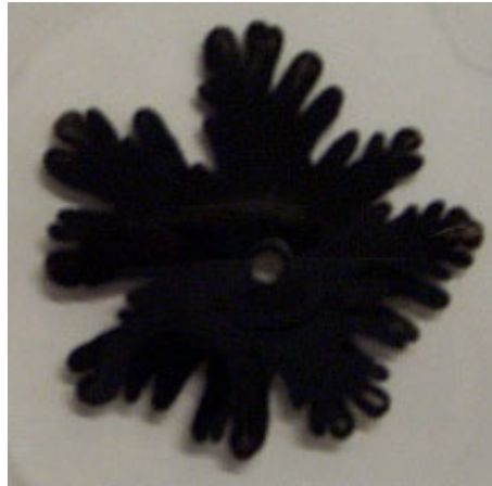
Figura 2: Fotografía del experimento 1. El líquido más externo es glicerina y el interno es tinta pigmentada.
