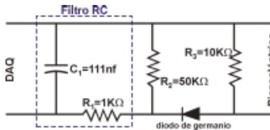
Figura 5 – Dispositivo de filtrado de la señal proveniente del piezoeléctrico. R_3 reduce la impedancia del piezoeléctrico para disminuir el ingreso de señales externas no deseadas; R_2 facilita la descarga veloz de C_1 ; el diodo se encuentra para eliminar la componente negativa de la señal que será enviada al sistema de adquisición de datos (DAQ).
