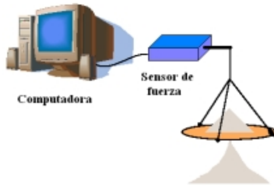
Figura 4.- Esquema del experimento del flujo de arena a través del agujero en un plato.
